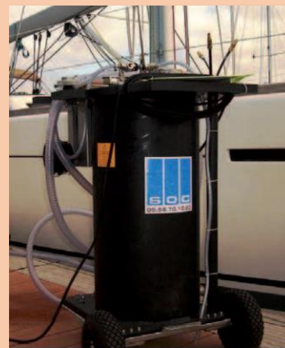
Pompe mobile – Eaux usées
